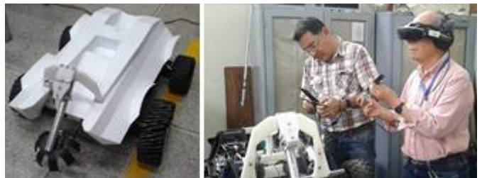
Figura 7: Prototipo Automin-1, sistema Cámara HD FPV y Radio Control.
